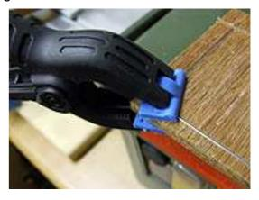
Als nächstes legen Sie die beiden Außenhänger (40mm) in die ausgefräste(geschnittene) Nut. Dabei achten Sie bitte darauf, das dass eine Ende auf dem Fahrdraht zu liegen kommt und fixieren den Hänger durch Auflegen eines Brettchens und Festklemmen mit einer weiteren Klemmzwinge:
