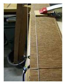
Wenn die Fahrleitung fertig ist bleibt nur noch das Versäubern der überstehenden Schweißenden. Nicht immer klappt es so genau das nicht doch noch ein Drahtstück am Fahrdraht hervorlugt, der u.U. einen anliegenden Schleifer beschädigt. Daher abschließend mit der Schleifmaschine (oder Feile) bündig mit dem Fahrdraht abschleifen.
